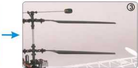
(3) 主旋翼旋转在同一平面 Main blades rotate in one plane.
