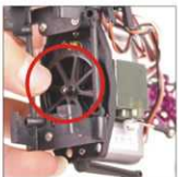
11. 主齿轮装入中心座组 Assemble the main gear on the central hub set.
